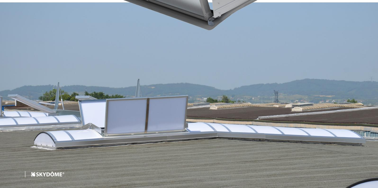
L'ARCADEF® ROOF Pneumatique est entièrement monté en usine. Sur chantier, l'installation en est grandement simplifiée. L'appareil nécessite seulement d'être posé et fixé sur la voûte. Adaptable sur les voûtes ARCADE® ayant une corde de 2000 à 4000 mm, son rayon constant de 2800 mm s'adapte à la voûte ARCADE de façon efficace et rapide.
